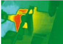
Motor: probleem met lagers
