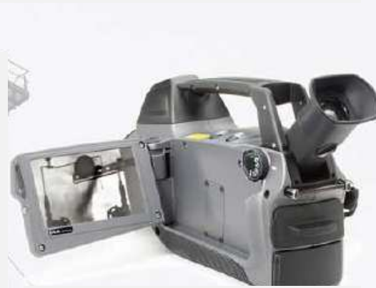
새로워진 면모 신형 GF306의 새로운 디자인은 대형 LCD 화면과 회전식 뷰파인더 등 옥외에서 사용하기에 편리하도록 기능을 보강하였으며 특히 인체공학적 설계가 강조되었다. GF306은 불과 2.4 kg의 경량이지만 탁월한 감도를 바탕으로 극히 미량의 가스 누출도 신속 정확하게 검출할 수 있다. 다양한 용도에 맞추어 렌즈를 교환할 수 있으며, 디지털 카메라와 GPS 기능을 내장하여 보고서 및 각종 관련 문서를 쉽고 보기 좋게 작성할 수 있도록 하였다
